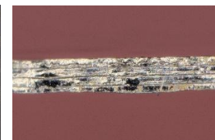
図2 多層箔材 で打ち抜き
