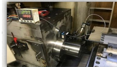
図4 品質確保のため放射温度計 の設置と測定
